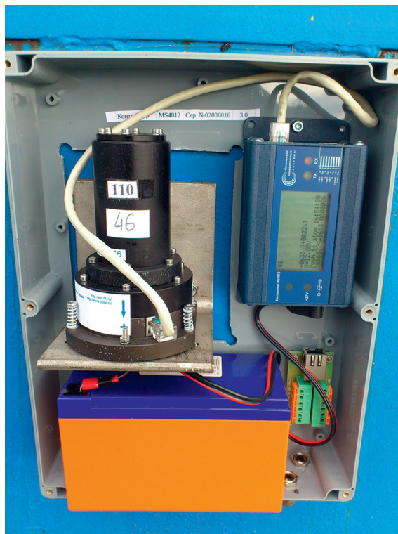
Рис. 5. Автономный пункт сбора данных
