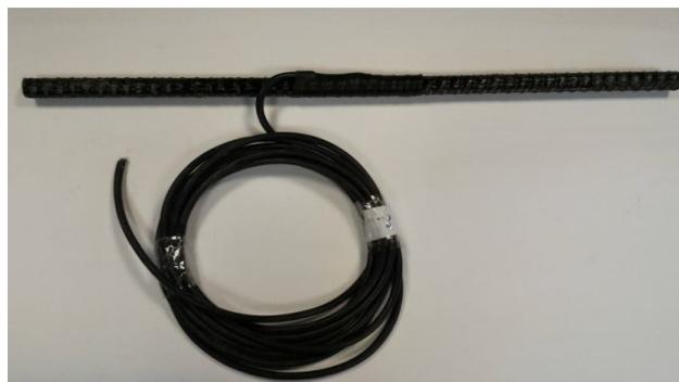
Рис. 1. Композитный датчик деформации КД120
